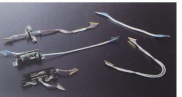
各同轴的外径为0.35~0.20mm的超细径，主要适用于手提电脑和手机的主板~LED之间的配线。此外，各同轴虽然是超细径，也可以制成双重屏蔽结构，从而提供具有优越耐噪特性的产品。
