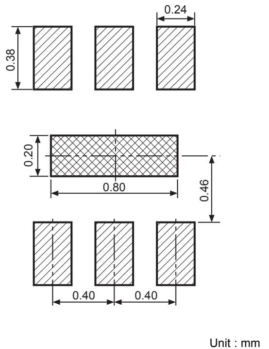
图15 HSNT-6(1212) 推荐钢网开口尺寸例
