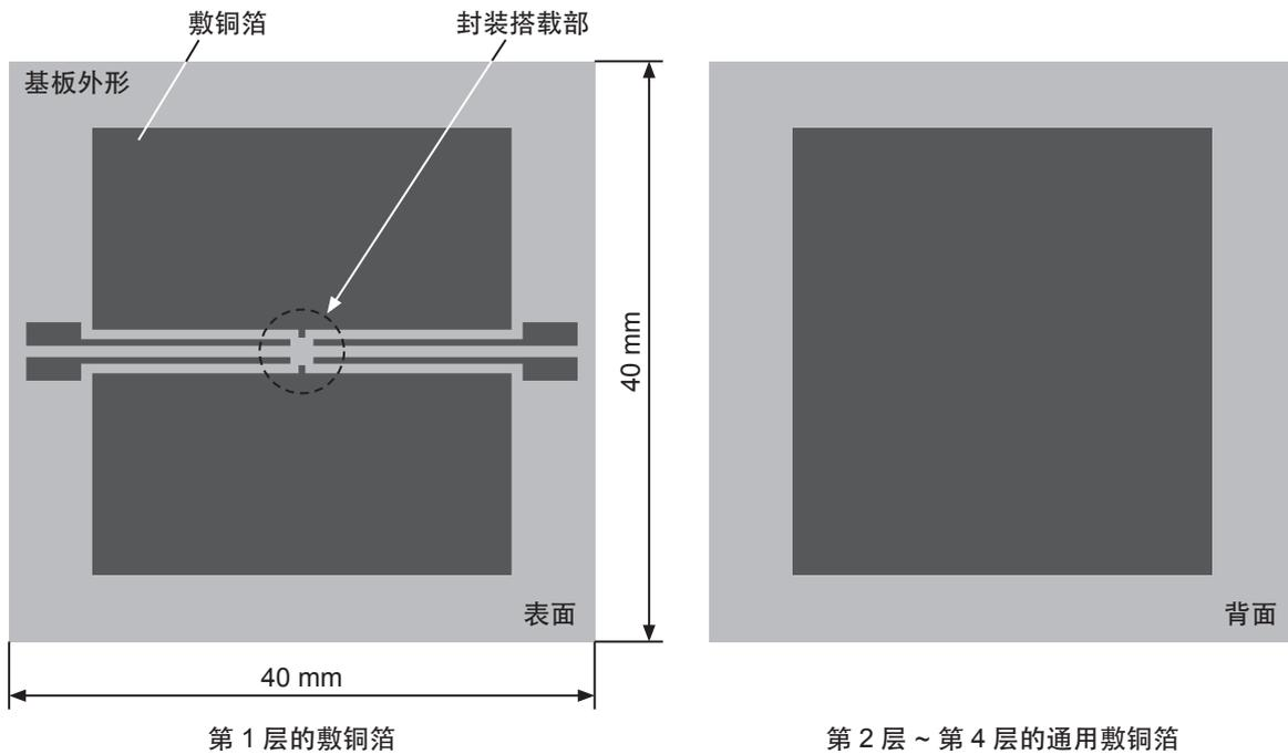
图23 高散热基板
