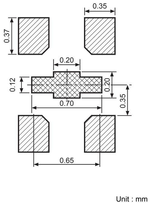
图11 HSNT-4(1010) 推荐钢网开口尺寸例
