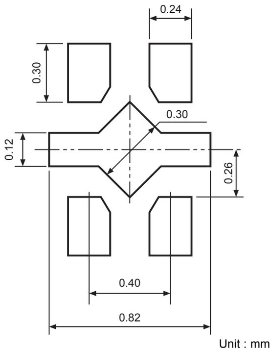
图6 HSNT-4(0808) 推荐焊盘尺寸例
