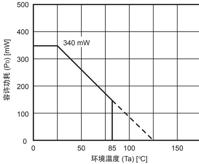
图19 HSNT-4(1010) 的容许功耗 (JEDEC标准基板)
