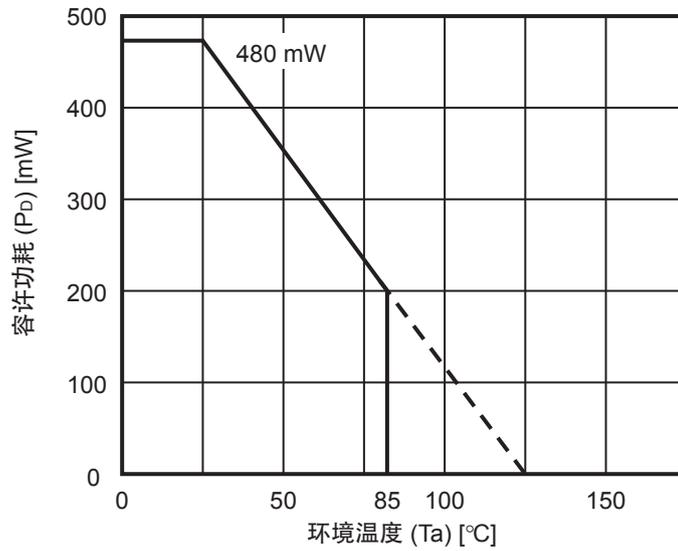
图20 HSNT-6(1212) 的容许功耗 (JEDEC标准基板)
