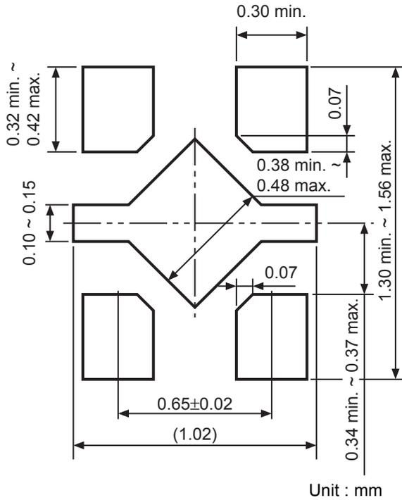
图8 HSNT-4(1010) 推荐焊盘尺寸
