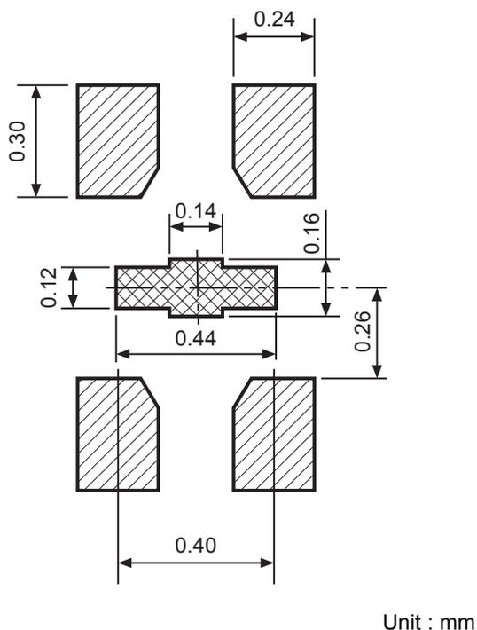
图7 HSNT-4(0808) 推荐钢网开口尺寸例
