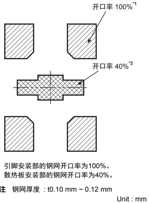
图9 HSNT-4(1010) 推荐钢网开口尺寸
