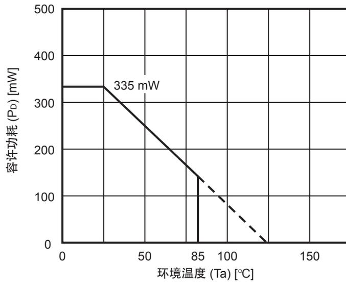
图18 HSNT-4(0808) 的容许功耗 (JEDEC标准基板)
