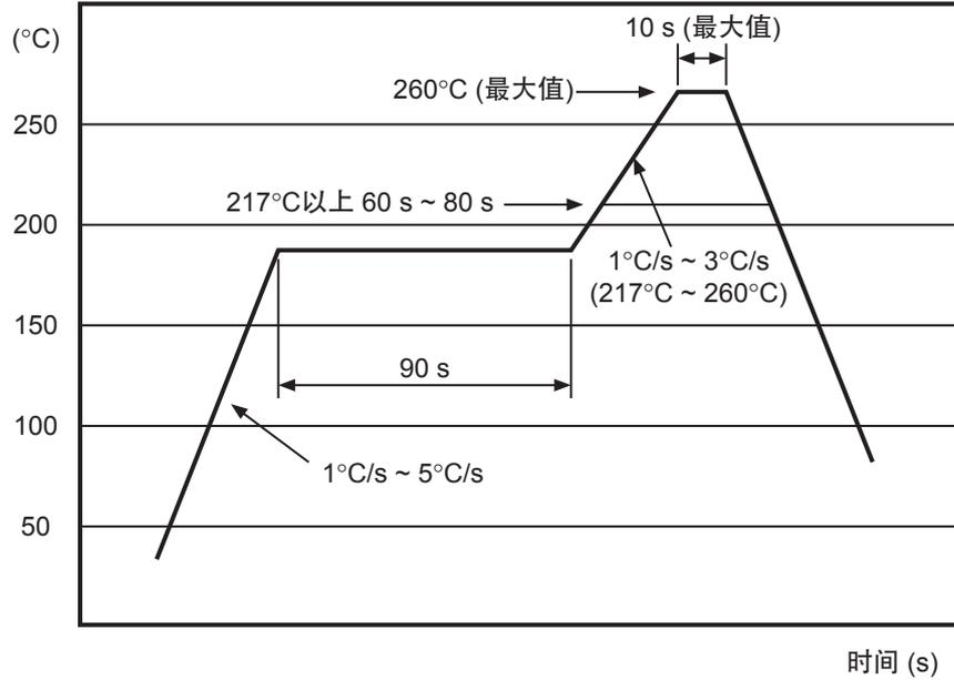
图17 耐热性评价用回流温度变化曲线
