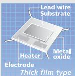
由于采用了丝网印刷技术，可实现自动化流水线大量生产，因此称为印刷型传感器。印刷型传感器品质非常稳定，可广泛运用于气体报警器以及空调、家电等产品中。
