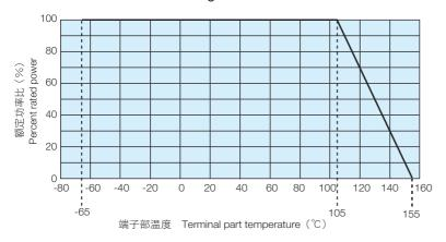
超过上述端子部温度使用时,请根据负荷减轻特性曲线减小额定功率后使用。
