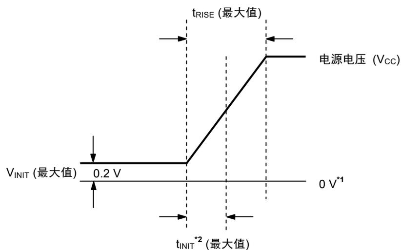
\*1. 0 V表示S-24CM01C的VCC端子与GND端子之间没有电位差。
