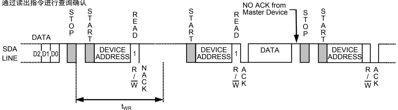
**备注** 使用通过写入指令进行查询确认时，在ACK输出后，可接着进行字地址、数据的输入。
