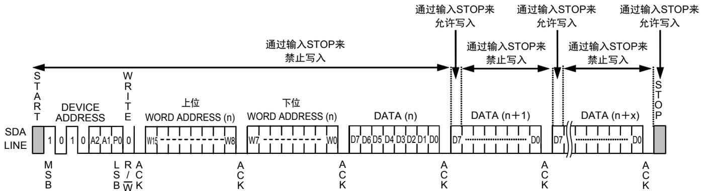
图29 通过在写入过程中输入停止状态来执行写入工作
