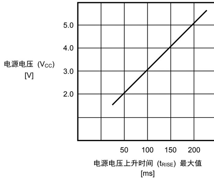
(例子) 使用的电源电压为5.0 V时：到5.0 V为止的到达时间请设在200 ms以内。
