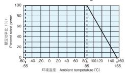
在环境温度85℃以上使用时,应按照上图负荷减轻特性曲线,减小额定功率。 For resistors operated at an ambient temperature of 85°C or above, a power rating shall be
