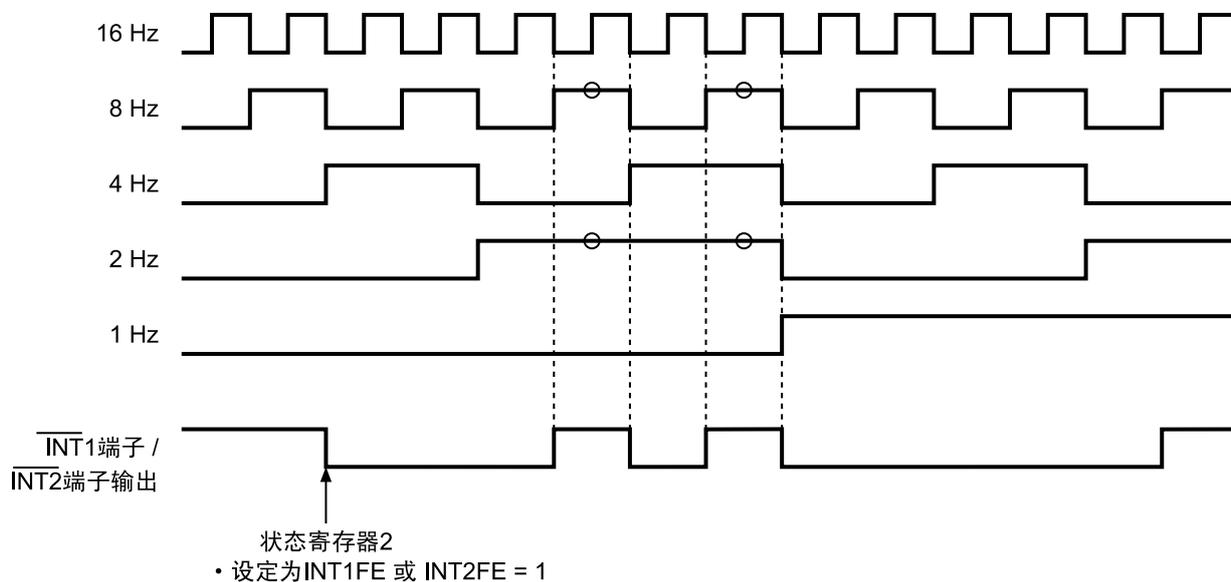
图15 INT1寄存器 (频率设定数据) 的输出例
