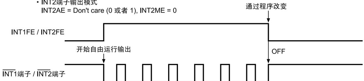
图27 频率设定输出时序
