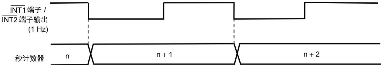
图16 1 Hz的时钟输出和秒计数器
