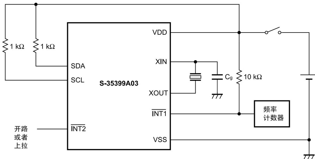
图56 振荡频率的测定电路构成
