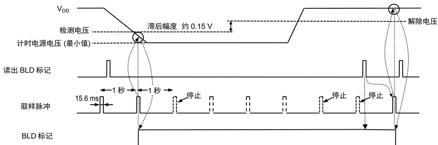
图23 低电源电压检测电路时序
