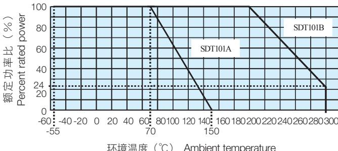
超过额定环境温度使用时，应按照上图的负荷减轻特性曲线，减小额定功率。
